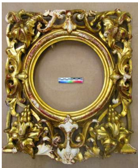
Илл. 12. Лицевая сторона створки после удаления непрофессионального лакового и красочного покрытия
