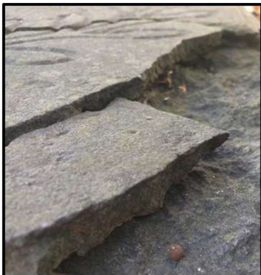
Рисунок 9. Надгробная плита М.П. Нефедовой, расслоившаяся по горизонтальной оси
